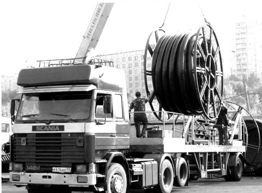
Рисунок 3.2 – Погрузка ГПИ-труб на барабанах
