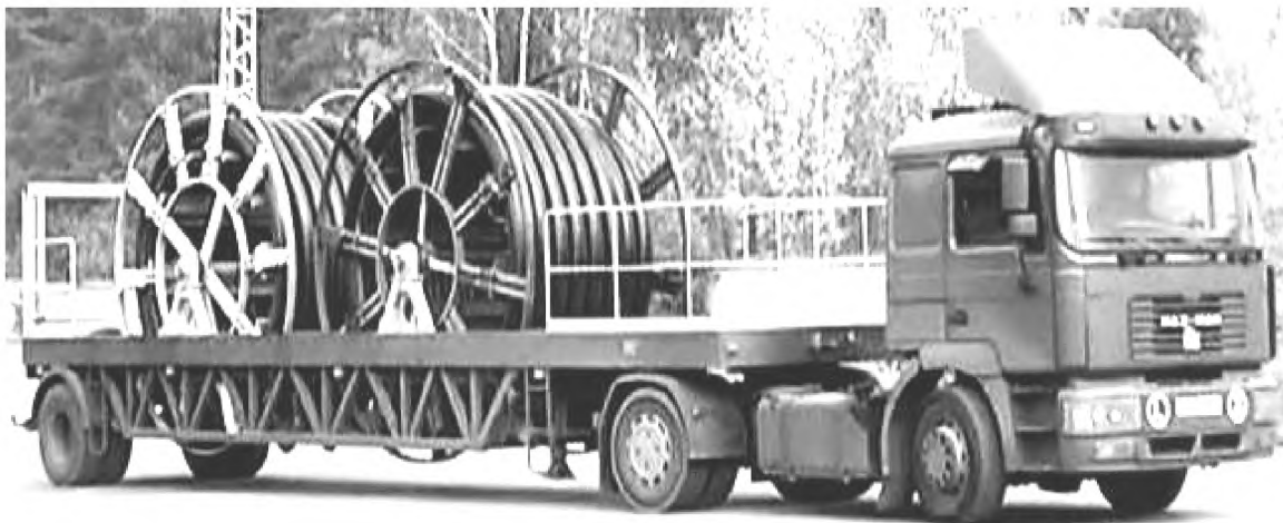
Рисунок 3.2а – Транспортирование ГПИ-труб на барабанах
